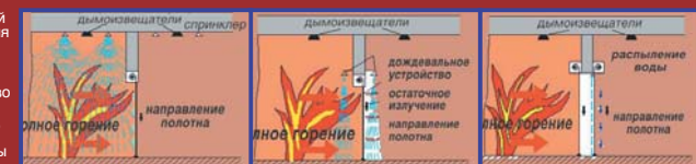
• Спринклер подавление огня через спринклеры
