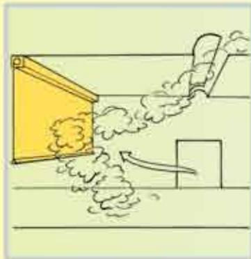
Mit Rauchschürzen kann die Wirksamkeit von **Entrauchungsanlagen optimiert** werden, d. h. je höher die Rauchschiebt, umso geringer die Abluftöffnungsflächen und die 1,5 mal größeren Zuluftöffnungsflächen.
