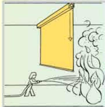
Durch die Rauchabschnittsbildung wird einer Verrauchung des gesamten Raumes entgegengewirkt und damit der Feuerwehr ein **besserer Löschangriff** ermöglicht, da sie den Brandherd lokalisieren kann.
