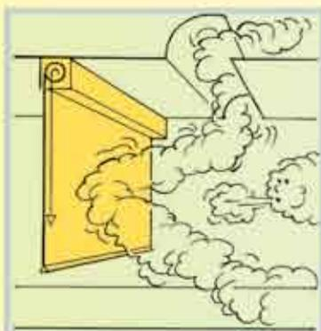
Bei **Querströmungen**, die aufgrund der Witterung ein Aufströmen des Rauches beeinträchtigen – besonders bei hohen Räumen – kann durch Rauchschürzen die sichere Strömung erreicht werden.
